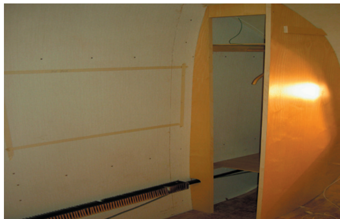
Del av värmesystemet i SMVs fullbreddare och början till en klädgarderob i bildens högra hörn.
